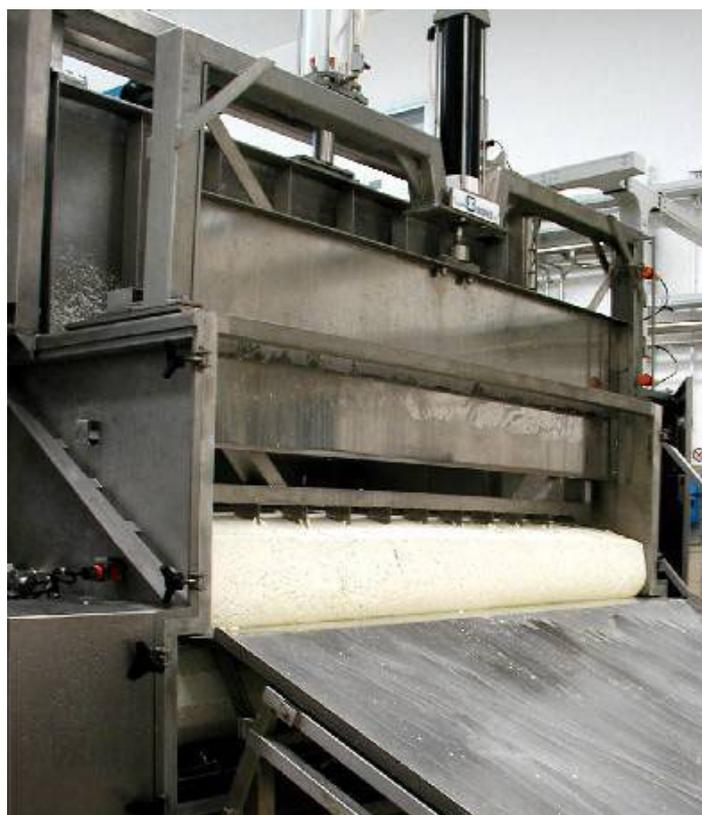
Après le transfert des blocs de caillé dans les moules, le fromage peut être envoyé à la ligne de pressage finale en conformité avec les technologies de production.
